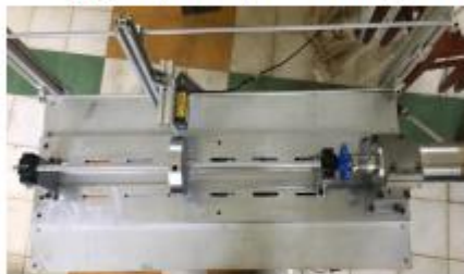
Rotor trong mô hình chạy thực nghiệm là 1 đĩa đơn được gắn đồng tâm trên một trục đàn hồi đồng nhất.
